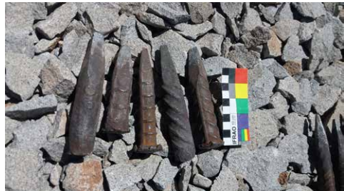
Figura 7. Lakanchira para afinar el ojal y cuñas para partir la pilastra. Fotos: Gabriela Behoteguy, 2018.
