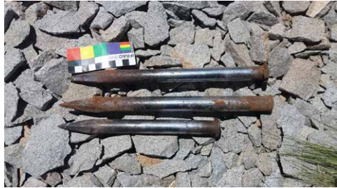
Figura 6. Qalltan punta para comenzar el ojal y mut'u punta para profundizarlo. Fotos: Gabriela Behoteguy, 2018.
