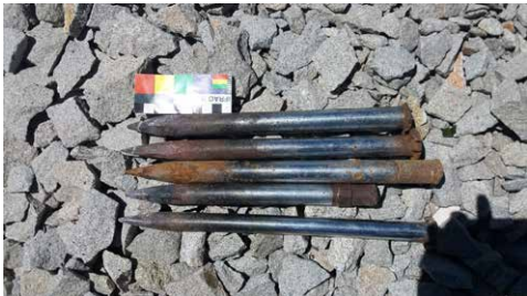
Figura 7. Lakanchira para afinar el ojal y cuñas para partir la pilastra. Fotos: Gabriela Behoteguy, 2018.
