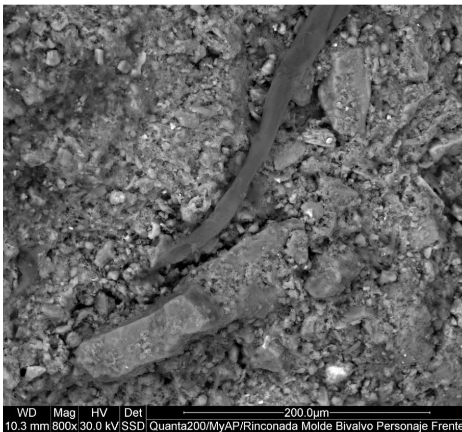
Figura 17. Microestructura de la zona donde se observa la fibra orgánica en el molde del personaje, 1000x. Laboratorio MyAP.
