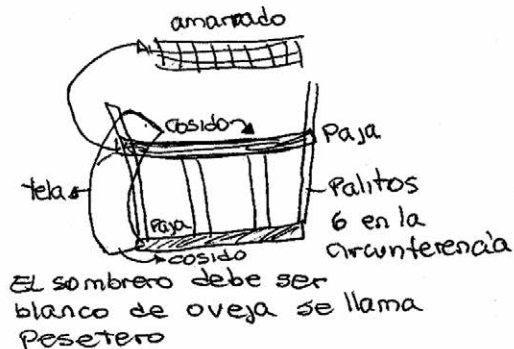
Figura 4.4. Detalle de la estructura del sombrero.
