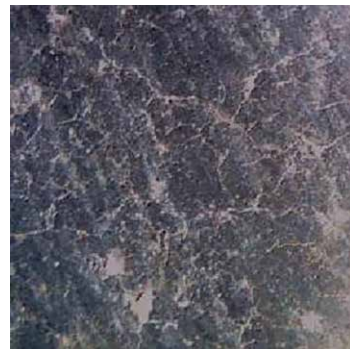
Figura 7. Micrografía de agrietamiento engobe
