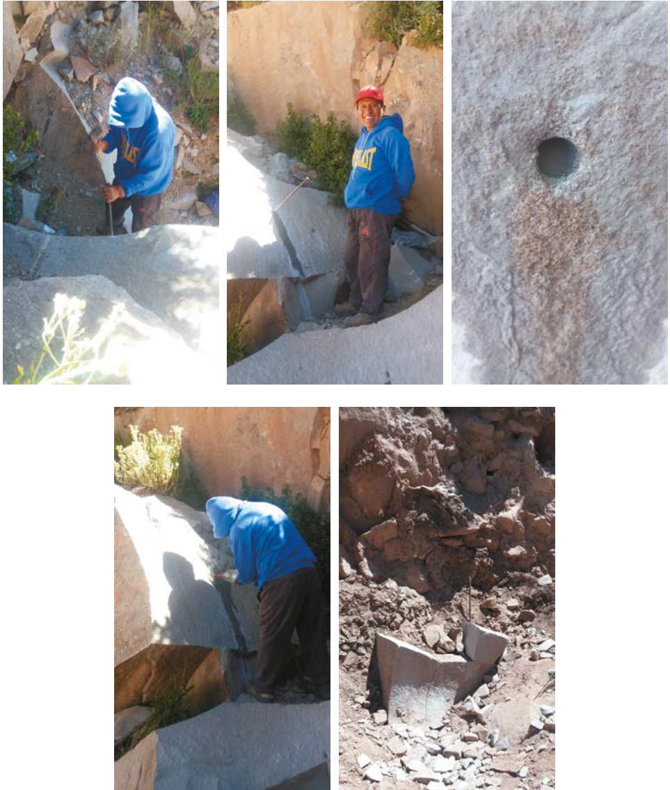
Figura 8. Técnica de barrenado, minero Gumercindo Mamani (Sección 3). Fotos: Gabriela Behoteguy, 2018.
