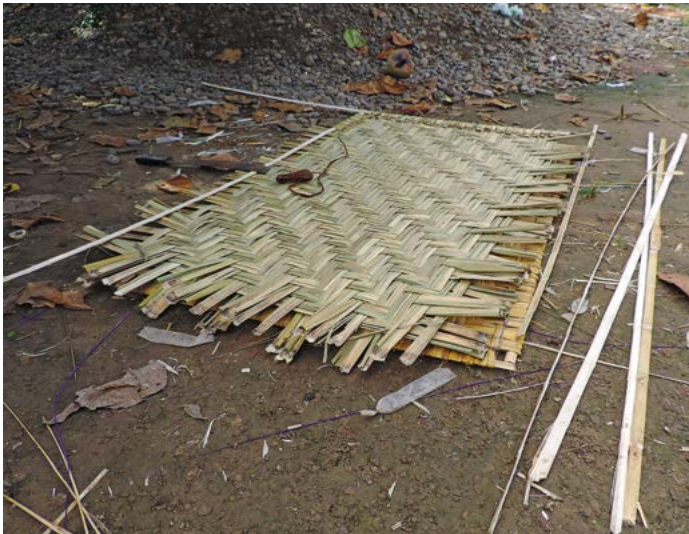
Figura 7. Estera rígida y soportes laterales de caña de charo a punto de tejerse. Foto: Fernanda Ballón.
