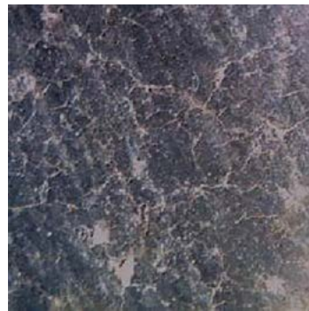
Figura 7. Micrografía de agrietamiento engobe
