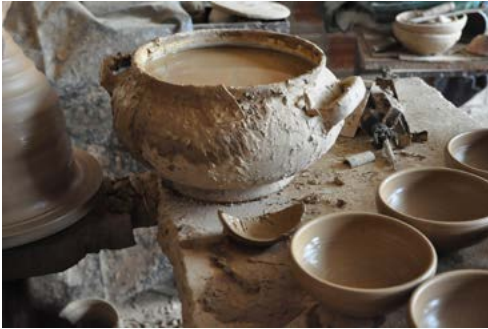
Figura 5. Herramientas (agua, cuero y fragmento de cerámica) para alisar la superficie de las vasijas en el proceso de torneado. Taller de Jacinto Vargas en Huayculí. Foto: Olga Gabelmann
