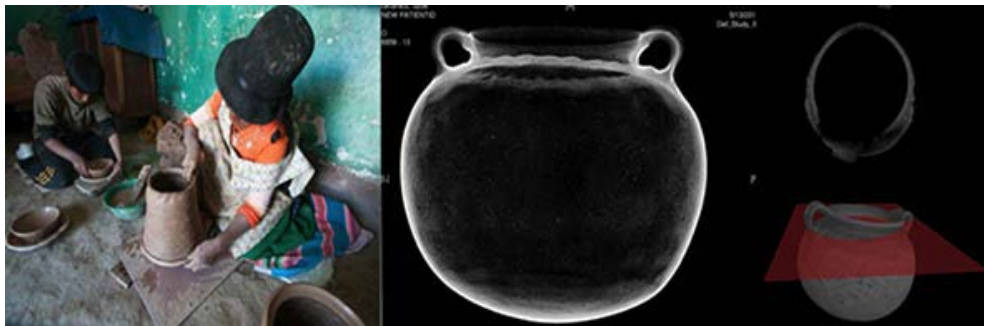
Figura 12. Izquierda, madre e hijo produciendo vasijas, compartiendo un ritmo de trabajo. En el medio, una radiografía de rayos x de una vasija elaborada por enrollamiento/ modelado manual/ modelado con espátula, producida en este hogar. Derecha una tomografía axial computarizada (CT-scan) (Tomografía computarizada) de la misma vasija.
